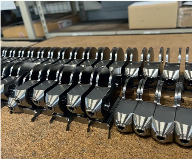
5 Die aus Titan gefertigten medizintechnischen Komponenten werden fünffach in Serie bearbeitet. Mit der Automatisierung erschließt sich der Lohnfertiger zusätzliche Kapazitäten in der Nacht oder am Wochenende
